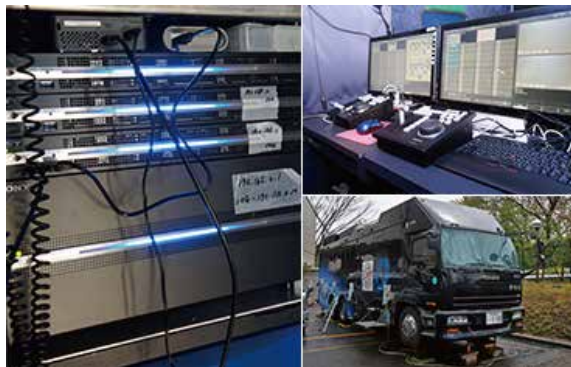
株式会社テレテック様の中継車HD-110 (写真・右下) に設置されたマルチポートAV ストレージユニットPWS-4400 (写真・左)。また、プロダクションコントロールステーションPWS-100PR1とUSB コントロールデバイスPWSK-4403 (写真・右上) でスロー運用などを実施。
