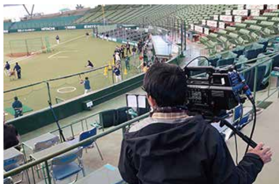
CineAlta 4K カメラPMW-F55 にカメラシステムアダプターCA-4000 を装着し、中継車内のベースバンドプロセッサユニットBPU-4000と接続することで4K/HD ライブシステムを構築。攻撃時/ 守備時など、撮影ポジションを変更して魅力的な映像を撮影。
