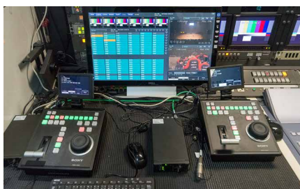
USBコントロールデバイス PWSK-4403、スローリプレイ制御に必要な各種操作ボタンやジョグダイヤル、フェーダーレバーを装備。
