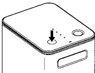
残量表示ランプ(緑色)が点灯し、電池残量を確認できます。
