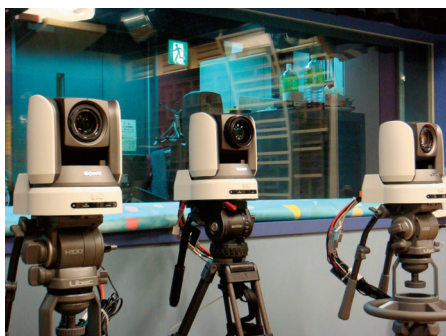
3式のBRC-Z700を三脚に取り付けて、1式を天井設置することで幅広い構図に対応。
