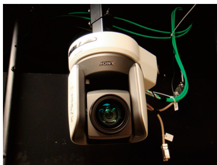
3式のBRC-Z700を三脚に取り付けて、1式を天井設置することで幅広い構図に対応。
