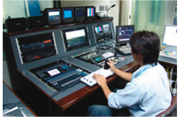
スタジオサブに設置されたRM-BR300でBRC-H700を遠隔操作
