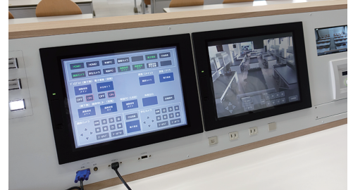
直観的な操作で簡単に遠隔講義が運用可能な専用教員卓。カメラ操作も画像上に直接タッチするだけでパン・チルト・ズーム操作が可能
