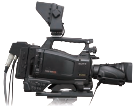
XDCAM EXカムコーダーPMW-350KにカメラアダプターXDCA-55を装着した状態
