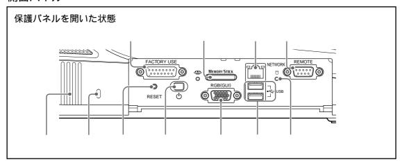
FACTORY USE端子 「メモリースティック」スロット ネットワーク端子( NETWORK ( RJ-45 ) リモートコントロール端子( REMOTE ) 内蔵ハードディスクアクセスランプ USB端子( USB ( USB準拠 ) オペレーション画面モニター端子
