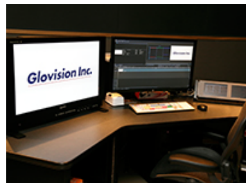
九段スタジオに新設されたDCP制作室のマスターモニターとして採用されたBVM-X300。SDから4K60pまでをサポートするDIワークステーションCLIPSTERと接続して運用中。
