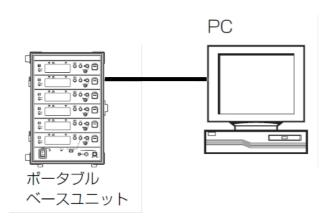
2. PB-01 の電源を入れ、CONFIGURATION -> CONFIG OTHER -> PB IP ADDRESSで PB-01 の IP アドレスを確認します。
