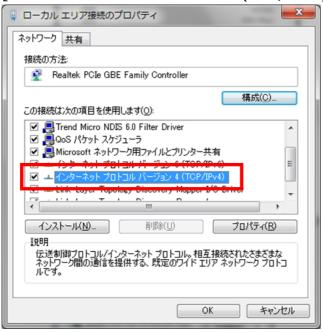
(7) [次の IP アドレスを使う]を選択し、IP アドレス、サブネットマスクを入力します。 2.で確認した PB-01 の IP アドレスに従い、各設定を行ってください。IP アドレスは PB-01 と異なるアドレスを 入力します。 たとえば、PB-01 の IP アドレスが 192.168.0.1 の場合、PC には 192.168.0.2 など、最後の数字が PB-01 と異なるように設定してください。 また、IP アドレスは、ネットワーク接 続する他の機器 と重複しないように設定してください。 各項目の設定後、 [OK]ボタンをクリックしてください。
