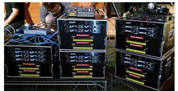
舞台下にはデジタルワイヤレスレシーバーDWR-R02DN/Gを配置して制御ソフトを有効に活用しながら同時多チャンネル運用の実証テストも行いました。
