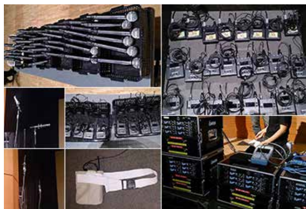
デジタルワイヤレストランスミッター、ラベリアルマイクロホン、デジタルワイヤレスレシーバーも32式、グランドプレーンアンテナと八木アンテナ7素子を24式、アンテナブラスター48式なども装備されました。
