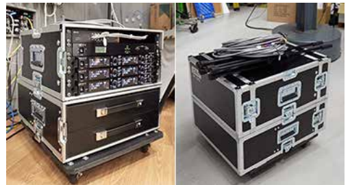
持ち出し用としてDWT-B01N/Gを8式とDWM-02N/Gを4式、計12波の運用に対応したほか、ゴルフ中継などを想定して1.2GHz帯対応八木アンテナ10本、ポータブルケースなども導入しています。ほかにラジオ用として1.2GHz帯14波での運用にも対応。
