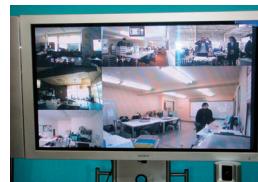
6画面で全拠点を表示。音声探知で発言拠点の映像がピックアップ表示される
