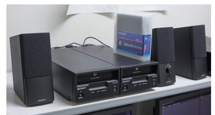
大容量・長寿命、保管のためのスペースとコスト面でのメリット、ランダムアクセスにおける優位性、そして再生互換を確保した状態で容量・転送速度に拡張性がある点などを評価してオプティカルディスク・アーカイブを採用。ドライブユニットとしてODS-D77Fを6台と、ODS-D77Uを4台採用。
