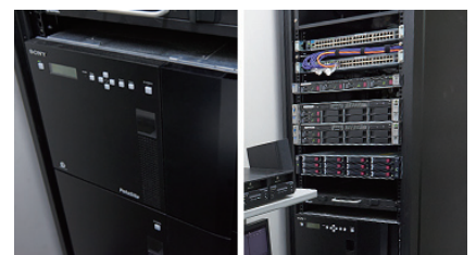
システムラックに収納されたオプティカルディスク・アーカイブPetaSite拡張型ライブラリーマスターユニットODS-L30Mと、ドライブ拡張ユニットODS-L60E。コンパクトながら大容量を実現、運用を止めることなくカートリッジ交換が可能な点やシステムの冗長性も評価されています。
