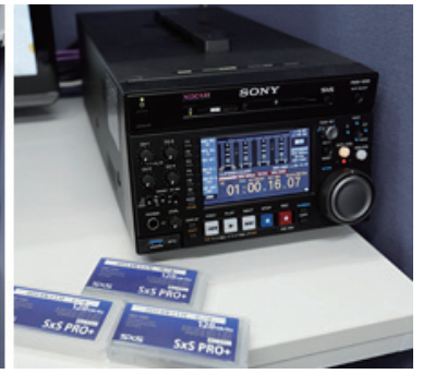
ファイル化を終えたコンテンツをSxSメモリーカードに記録し、XDCAM HD422レコーダーPMW-1000を使ってプレビュー、最終確認を行います。SxSメモリーカードを使ってプレビューを行うのは、クオリティや表現などを綿密にチェックするためです。
