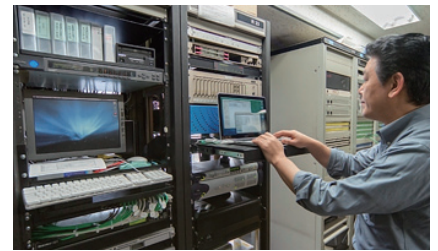
オプティカルディスク・アーカイブドライブユニットODS-D77Uは、ファイルオペレーション用に用意されたMacBook ProのUSB3.0ポートに直接接続される。インターフェースに汎用的なUSB3.0を採用しているため、特別なインターフェースを増設する必要なく、幅広いPCと接続が可能
