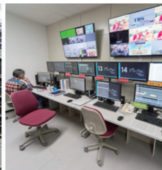
報道フロア内の回線収録・インジェストブース。XDCAM Station XDS-1000を5式使用し、さまざまなフォーマットの報道取材映像のインジェストならびに回線収録を行います(左)。同時に、メタデータの付加作業を端末で行います(右)。
