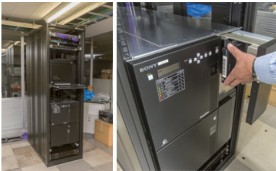
ODS-L30MとODS-L60Eを利用し、ドライブユニットODS-D77Fを合計4式併用、合計91巻のオプティカルディスク・アーカイブカートリッジを格納でき、最大約136.5TBの内蔵ストレージ容量を確保しています。
