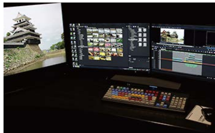
編集室にはHDRに対応したBVM-X300を導入し、S-Log3ワークフローの一貫した4K HDR制作を行っています。
