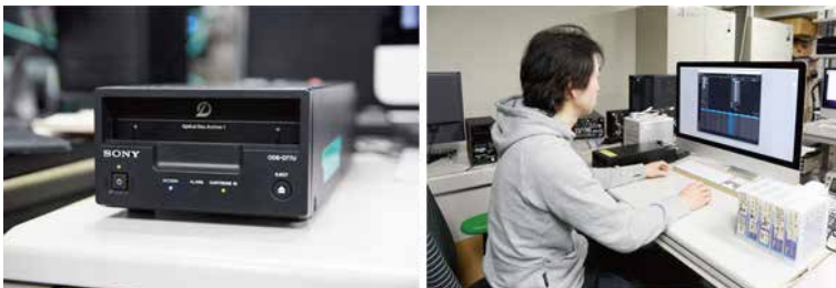
マシンルームに設置されたオプティカルディスクアーカイブドライブユニットODS-D77U。
