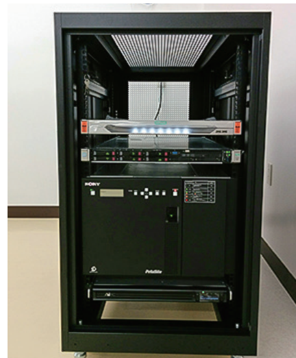
今回導入した光学ディスク・アーカイブ PetaSite 拡張型ライブラリーマスターユニット ODS-L30M、ドライブユニット ODS-D280F。
