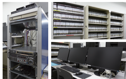
テープ資産のファイルベースアーカイブへの移行をサポートするデジタルシステム、PWS-100TD1も1式導入。膨大なテープアーカイブを効率的にデジタル化し、ODAへの転送作業もスタートしました。
