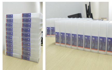
第2世代 ODA カートリッジ ODC3300R。3.3TBの大容量、読み出し2Gbps、書き込み1Gbpsの高速性、100年以上の保存耐久性を実現した点が評価されました。
