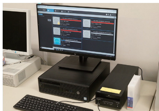
データ管理を行うドライブユニット ODS-D280U と管理システム Memos MD 操作端末
