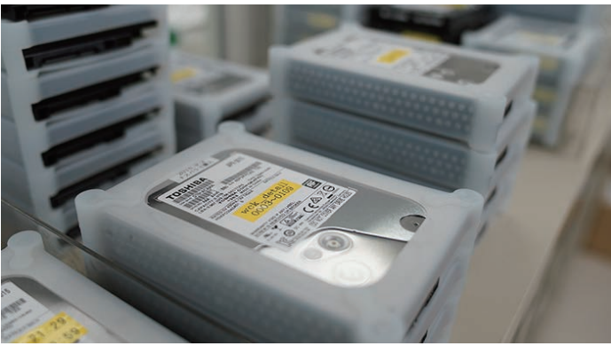
山積みになるHDD。テープ同様に棚で管理する
