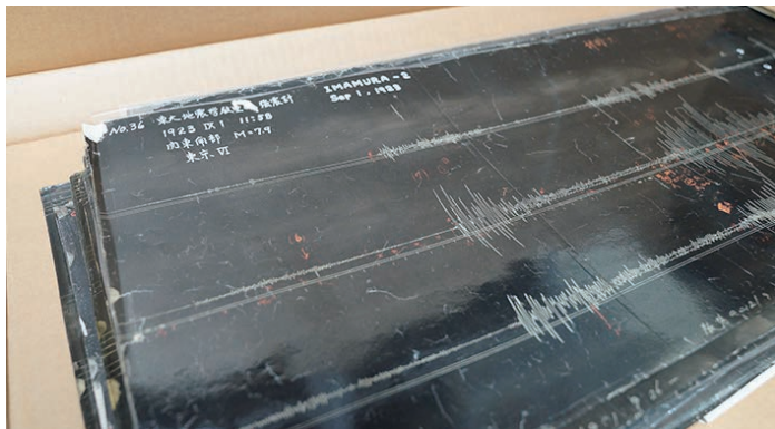
すす書き記録。フィルムにより表面をコーティングし劣化を防ぐ処置済みの記録
