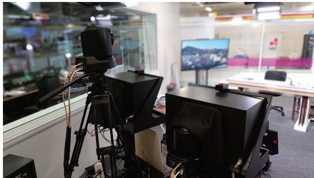
3台のBRC-H800のうち、2台はプロンプターにセットされている
