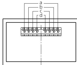
2-aを選んだ場合、ベースアダプター①をネジ(PSW 4x10)②でベース(20)③に確実に取り付ける。
