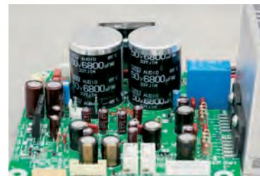
ケース形状やスリーブの材質、長さまでこだわった特注のブロックコンデンサーを使用する
