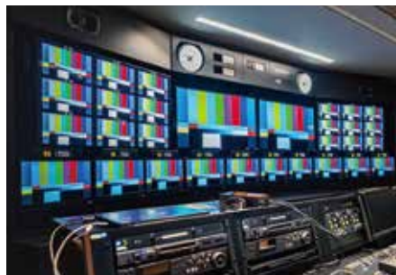
モニター棚、メインの2枚にはPVM-X550を採用。 操作卓からの目線に配慮した配置
