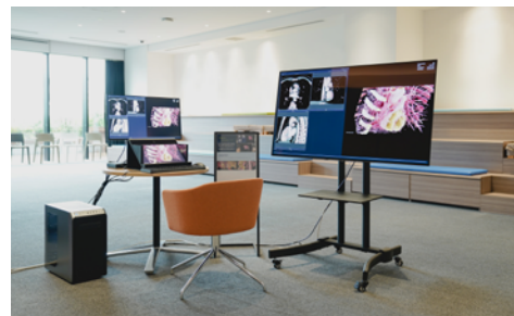
左が ELF-SR1/BZ、平面ディスプレイの併設で DICOM 画像との 2 画面表示にも対応
