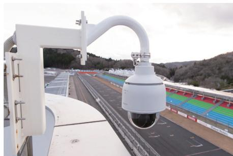
トップスピードのレースカー映像を捉えるコントロールタワーのドームカメラSNC-WR632
