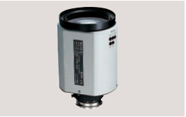
17倍リモコンズームレンズ VCL-717BXEA 希望小売価格300,000円(税別) ●焦点距離:7~119mm ●電動フォーカス、電動ズーム、リモートアイリス ●別売リモートコントロールユニットRM-C950によるコントロールが可能 ●パヨネットマウント
