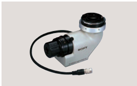
顕微鏡アダプター MVA-265 希望小売価格600,000円(税別) ●パヨネットマウントのカメラを顕微鏡に接続可能 ●適合顕微鏡:C.Zeiss社製OPMIシリーズ、TOPCON社製600シリーズ ●外形寸法:148(幅)×92(高さ)×50(奥行)mm
