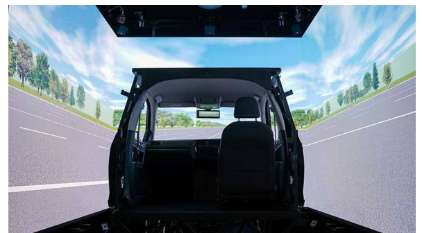
精巧なドライビングシミュレータの正面と左右にコの字型にCrystal LEDを配置
