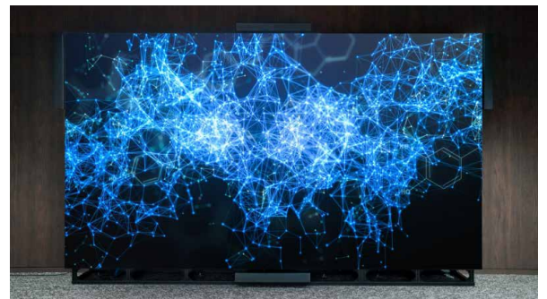
CTC内のシアタールームに設置されたCrystal LEDと画面の上下左右に配置したラインアレイスピーカー SLS-1A
